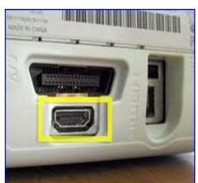
8. منفذ (**HDMI**) : وهو منفذ يقوم بربط جهاز الحاسوب الخاص بك بأجهزة التلفاز أو الشاشات الخارجية أو أجهزة العرض، حيث يعمل على بث الصور بدقة عالية جداً وبوجود صوت أيضاً، ويتم ذلك إذا كان جهاز الحاسوب الخاص بك يحتوي على منفذ (HDMI) والشاشة الخارجية التي تزيد وصل جهاز الحاسوب الخاص بك بها تحتوي على وصلة أو مكان للوصلة DVI ، فقد يكون من السهل جداً التحويل من جهازك إلى شاشة العرض باستخدام محول تكلفته قليلة .
